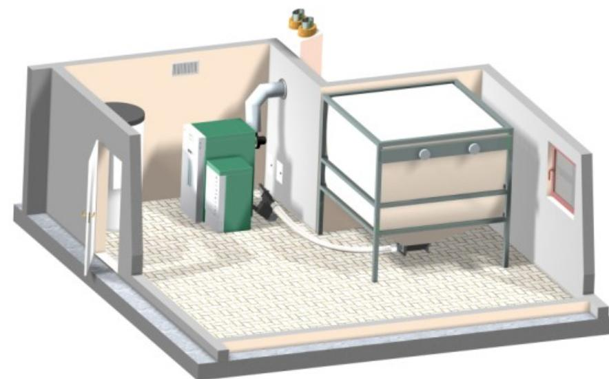
Doprema iz platnenog silosa – za pelete
