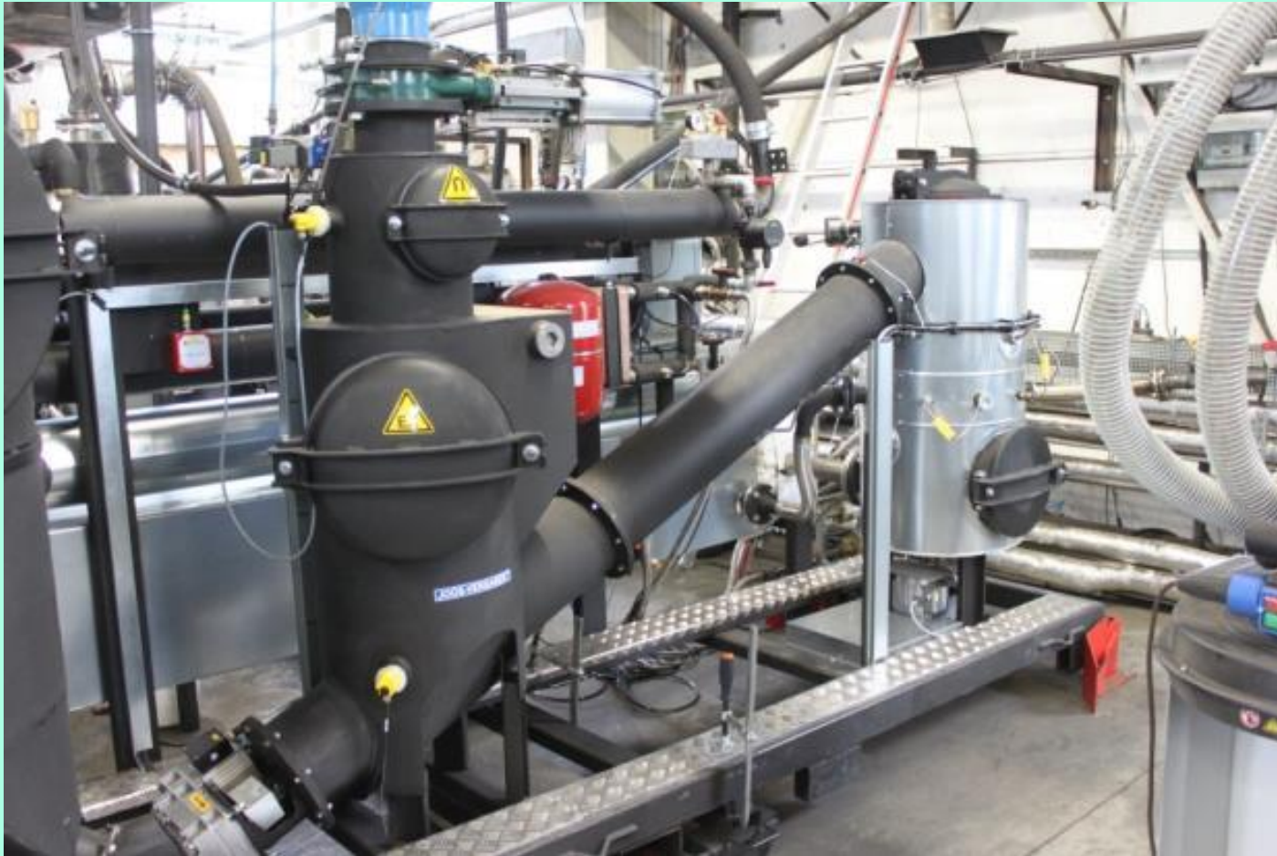
Postrojenje za uplinjavanje biomase male snage firme „SpannerRE2“ (Izvor: Rutz D.)
