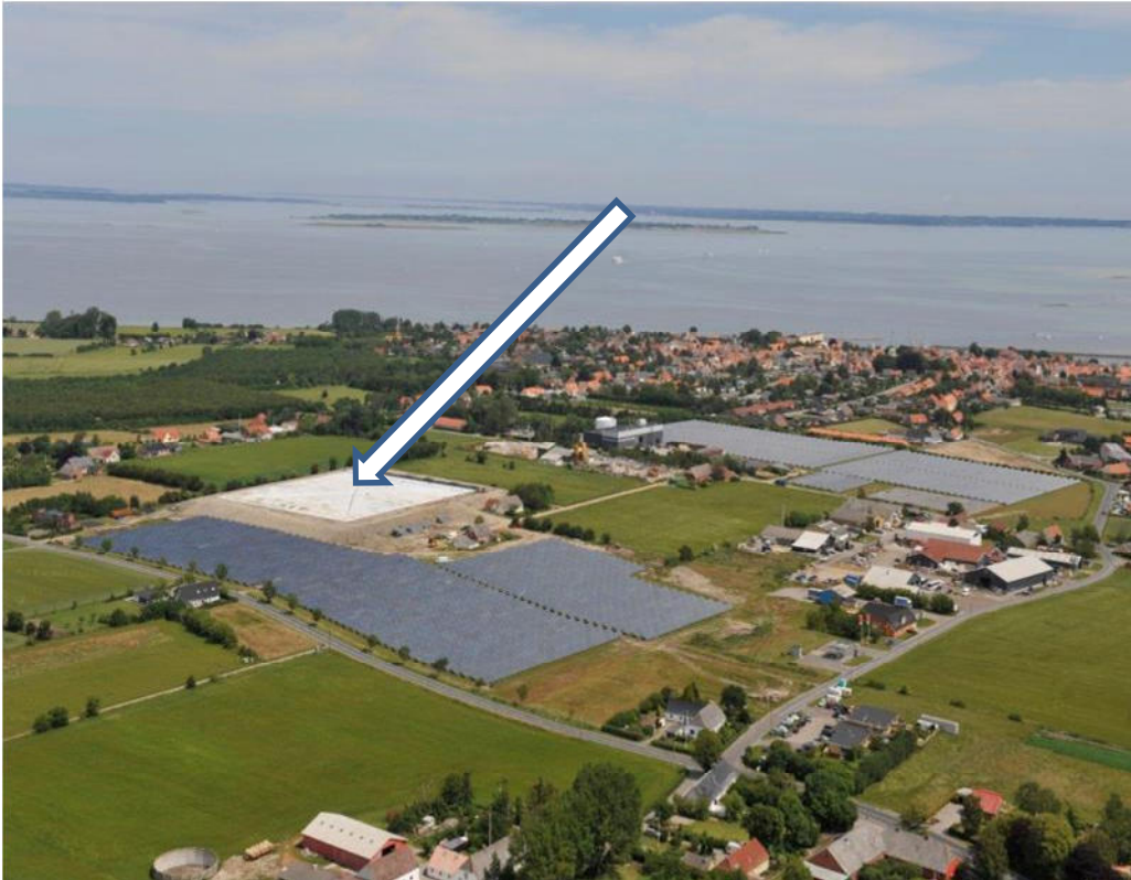
Slika 44: Shranjevanje toplotne energije v izolirano jamo v Marstal, Danska (Vir: PlanEnergi)
