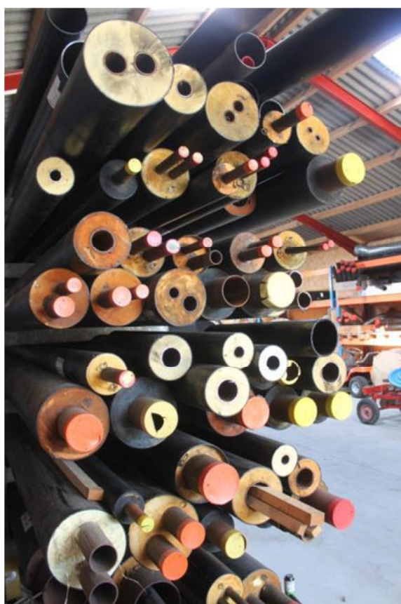
Slika 50: Primeri starih jeklenih cevi (levo) in dvojne polimerne cevi (desno) (Vir: Rutz D.)
