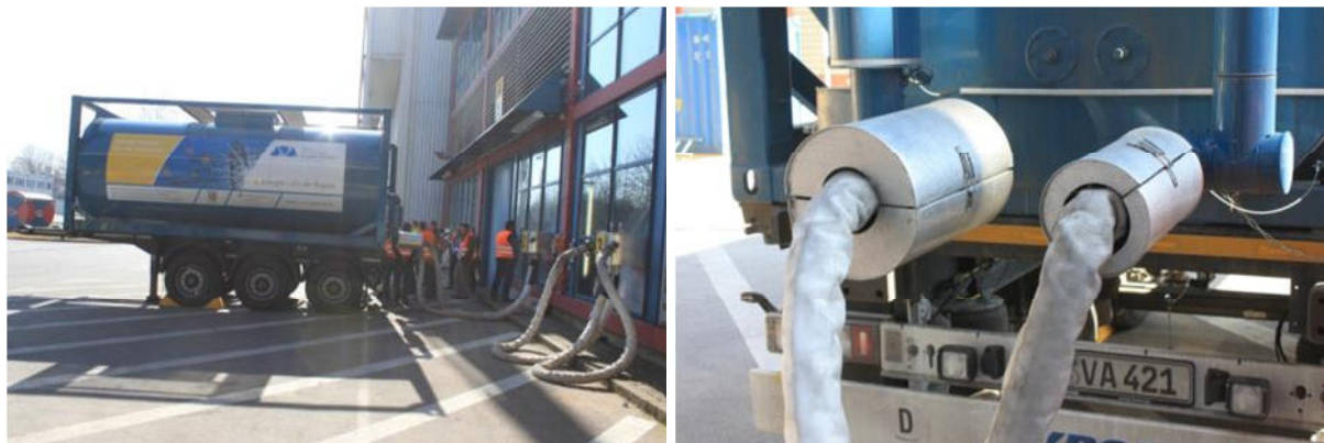
Slika 42: Kontejner za shranjevanje toplote na prikolici (Augsburg, Nemčija) (Vir: Rutz D.)
