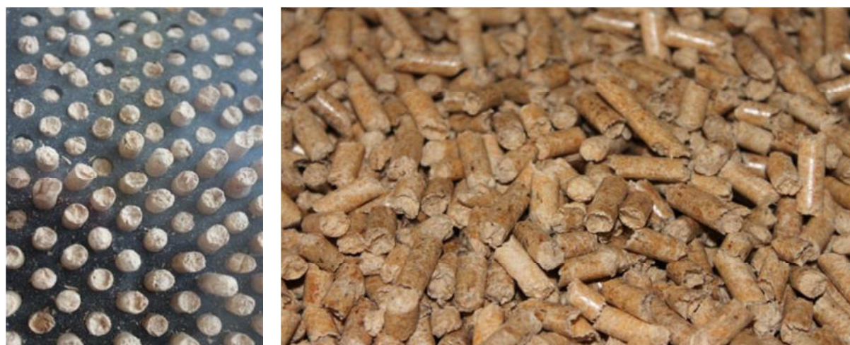
Slika 13: Stiskalnica za izdelavo peletov (levo) in peleti visoke kvalitete (desno) (Vir: Rutz D.)
