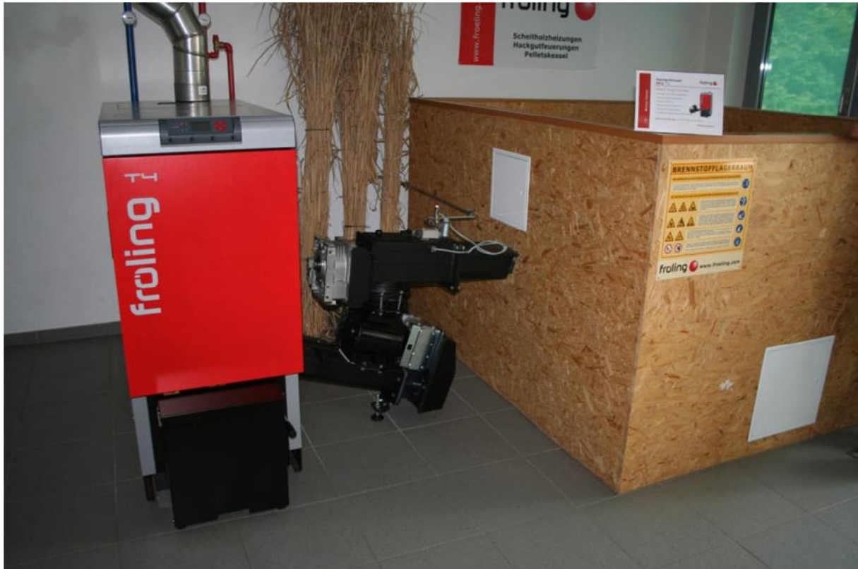
Slika 15: Majhni sistem ogrevanja na lesne sekance (24-50 kW) kotel (levo), sistem transporta goriva (sredina) in zalogovnik sekancev (desno) proizvajalca Fröling (Vir: Rutz D.)
