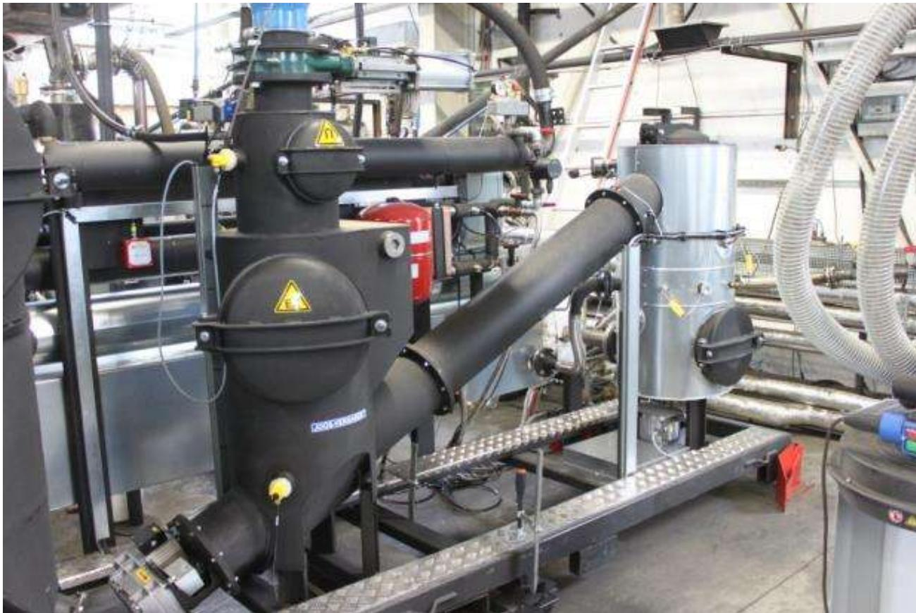
**Gasifikacija biomase u postrojenju male snage tokom rada (levo) i tokom proizvodnje (desno) firme „SpannerRE<sup>2</sup>“ (Source: RutzD.)**
