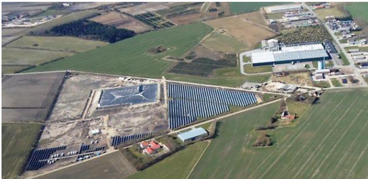
**Slika 4. Sezonski spremnik topline I sunčevi kolektori u izgradnji. Na desnoj strani postrojenja se vidi postojećih 10 000 m<sup>2</sup> sunčevih kolektora, dok na desnoj se vidi izgradnja novih kolektora te spremnika topline. Izvor: Gram Fjernvarme**
