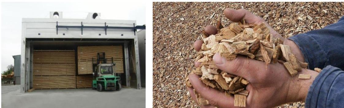
Slika 21. Sušare se griju toplinom iz CTS-a (lijevo). Gorivo koje se koristi u kotlovima je drvna sječka (desno) (Izvor: Güssinger Fernwärme GmbH)
