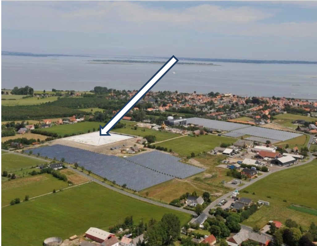
Slika 32. Skladište toplote u obliku izolovane jame, Marstal, Danska (Izvor: PlanEnergi)
