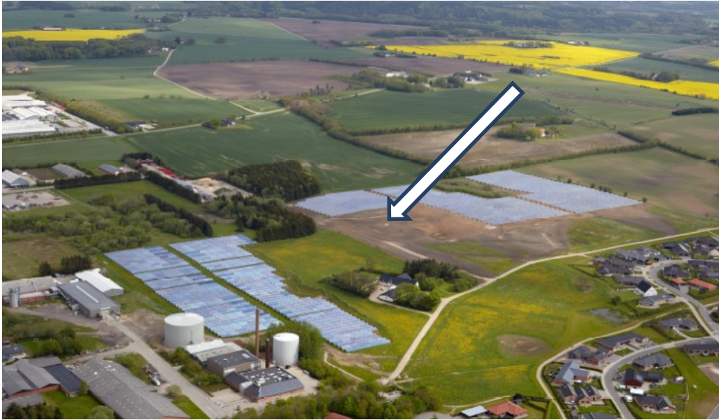
Slika 34. Skladište toplote u obliku bušotine u sklopu solarnog SDG u Brødstrup, Danska (Izvor: PlanEnergi)
