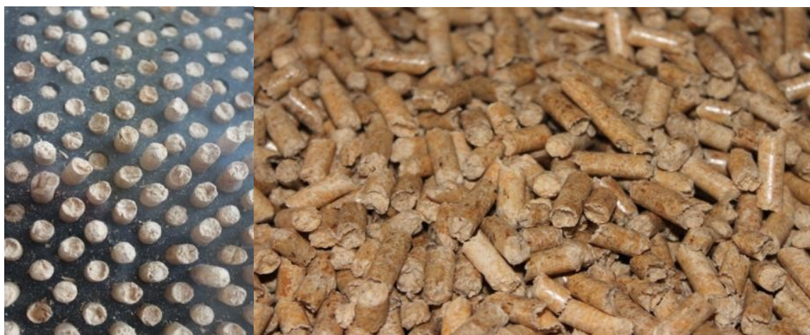
Slika13. Matrica za pelet (levo) i visoko kvalitetni pelet (desno) (Izvor: RutzD.)
