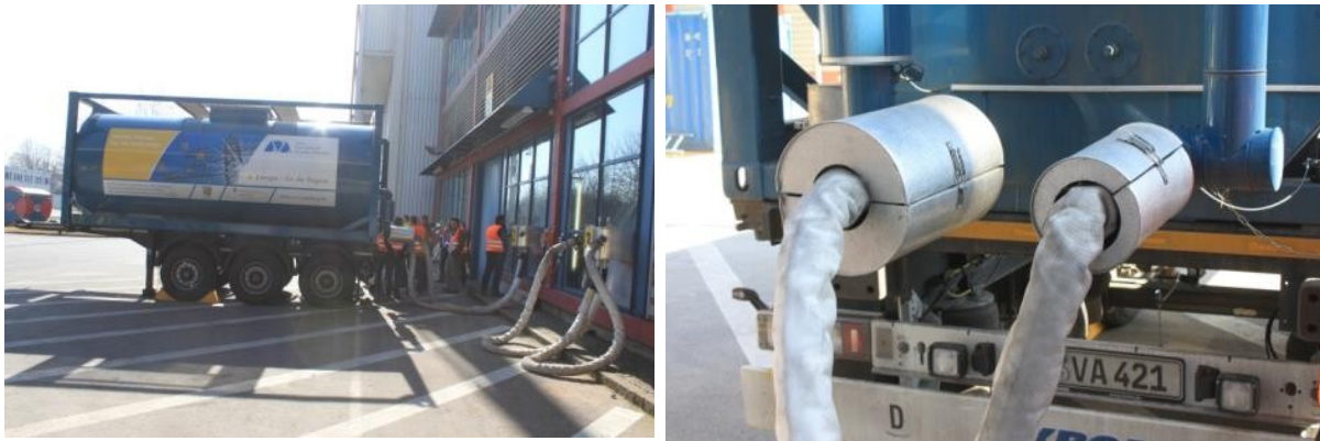
Slika 30. Kontejner za skladištenje toplote u spalionici otpada (Augsburg, Nemačka) (Source: Rutz D.)
