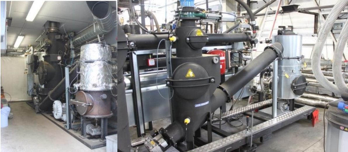
Slika21. Gasifikacija biomase u postrojenju male snage tokom rada (levo) i tokom proizvodnje (desno) firme „SpannerRE 24 “ (Source: RutzD.)
