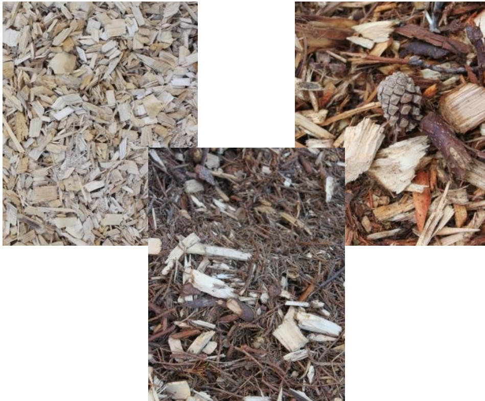
Slika14. Drvna sečka visokog (levo) i niskog kvaliteta (sredina i desno) (Izvor: RutzD.)
