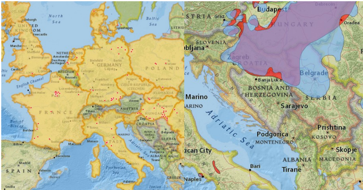
Slika30. Karta koja pokazuje postojeće geotermalne (crvene tačke) SDG (levo) i potencijali korišćenja geotermalne energije (desno); Legenda: temperatura >50 °C na 1 000m dubine (plavo), temperatura >90 °C na 2 000m dubine (crveno), preklapanje ovih dvaju područja (ljubičasto) (Izvor: http://map.mfqi.hu/geo_DH/ )
