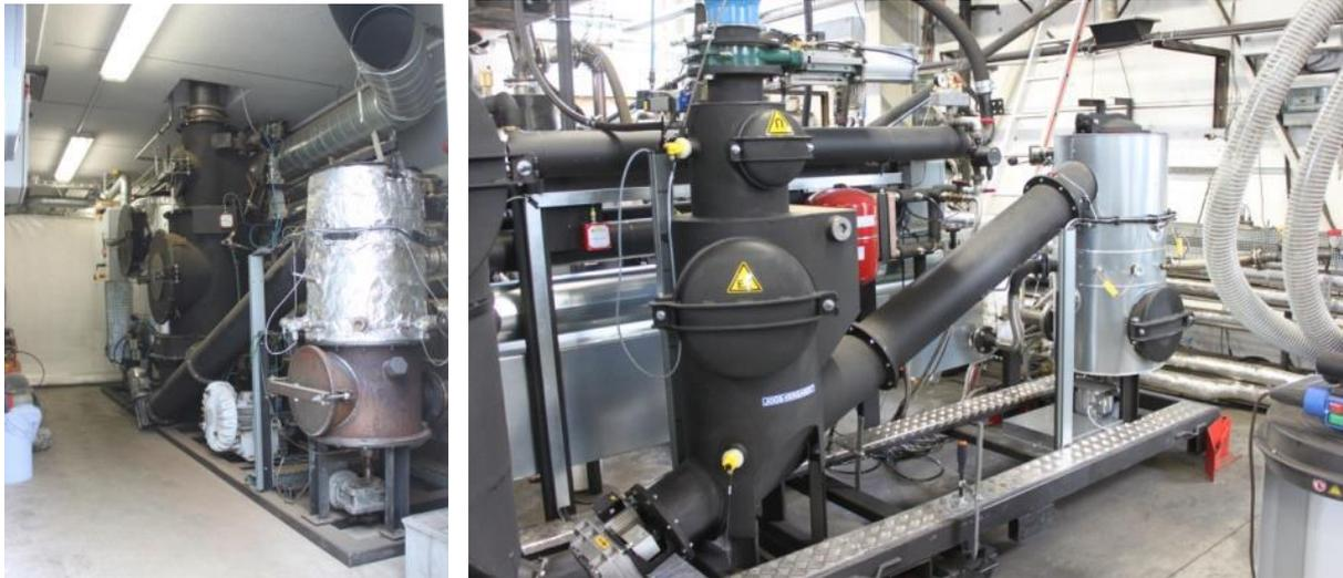
**Abbildung 21:** Kleine Vergaseranlage der Firma "SpannerRE<sup>2</sup>" für Hackschnitzel in einem Container (links) und auf dem Prüfstand des Herstellers (rechts) (Quelle: Rutz D.)
