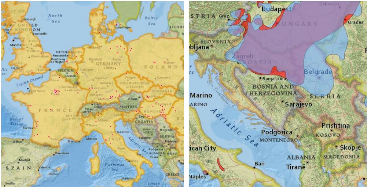
**Abbildung 30:** Karten mit vorhandenen geothermischen Wärmenetzen (rote Punkte) (links) und Potential für Geothermie (rechts); Legende: Temperatur > 50 ° C bei 1.000 m Tiefe (blau) und Temperaturverteilung > 90 ° C bei 2.000 m Tiefe (rot); Lila Farbe = Überlappung der beiden Schichten (Quelle: [http://map.mfqi.hu/geo\\_DH/](http://map.mfqi.hu/geo_DH/))
