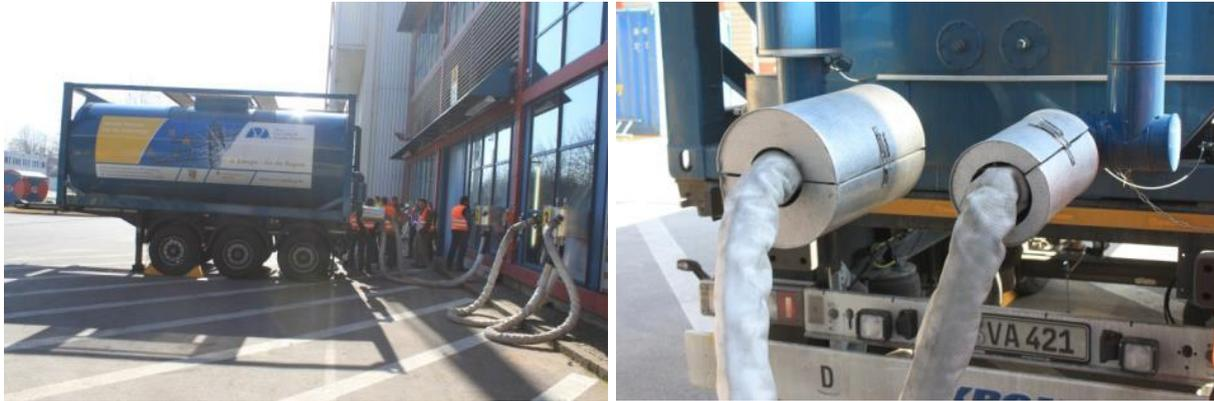
Abbildung 42: Mobiler Wärmespeichercontainer einer Müllverbrennungsanlage (Augsburg, Germany) (Quelle: Rutz D.)
